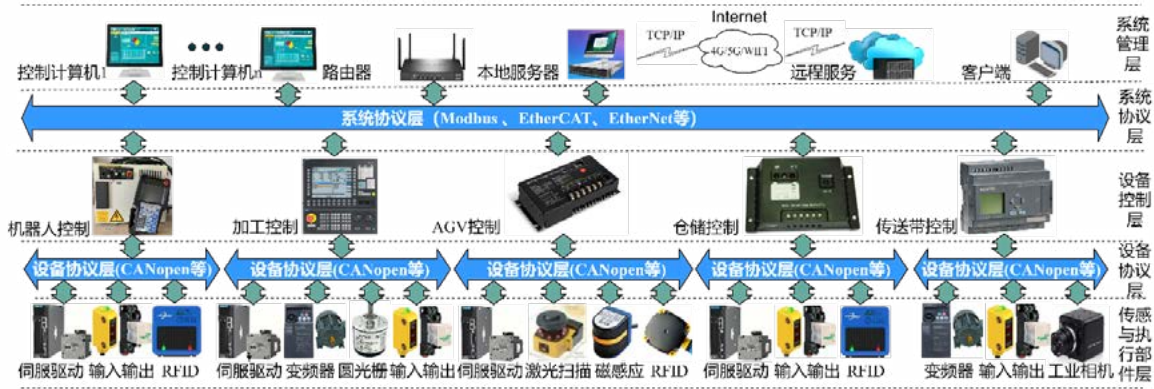
图 2 典型智能制造系统的网络与控制结构
